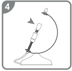
Remplazar la lámpara por una nueva. Se recomienda utilizar una lámpara led perfume de 2w E14.
