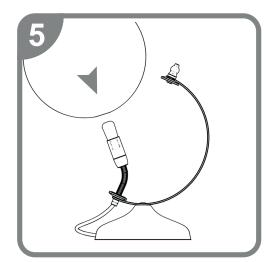
Colocar nuevamente el globo en la base introduciendo la lámpara por el agujero inferior inclinando el soporte fexible.
