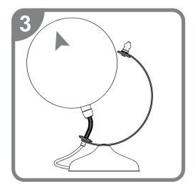
Retirar el globo con cuidado de no dañarlo contra el metal del arco y los ejes. El portalámparas se encuentra montado en un soporte flexible para poder realizar está operación.
