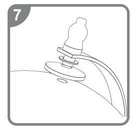
Tener especial cuidado al volver a introducir el eje en el globo. Deben quedar las 2 arandelas en la posición correcta como se ve en la imagen.
