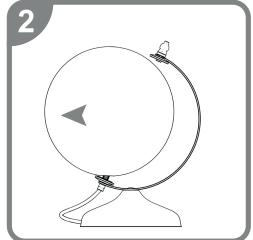
Esto permite desembocar el globo de su eje superior para poder retirarlo, con precaución de no dañar la superficie impresa. Desplazar el globo hacia afuera para poder retirarlo.
